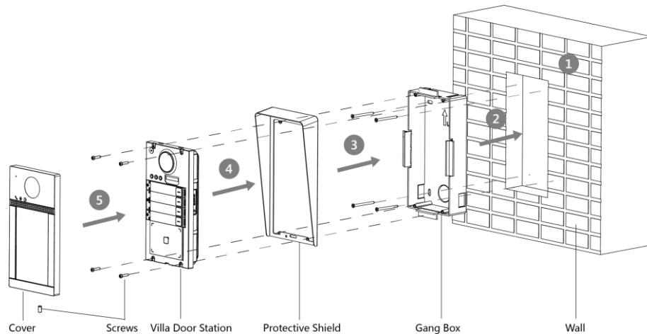
Рисунок 3-7. Врезная установка с защитным козырьком
